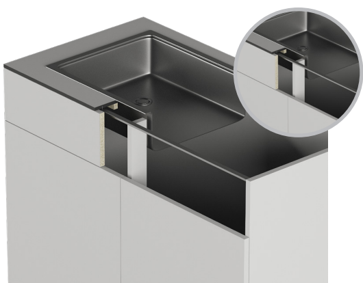
Изображение 50: стабилизация конструкции с помощью металлической планки
