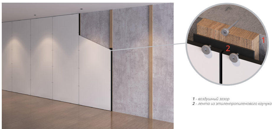
Изображение 25: видимое механическое крепление
