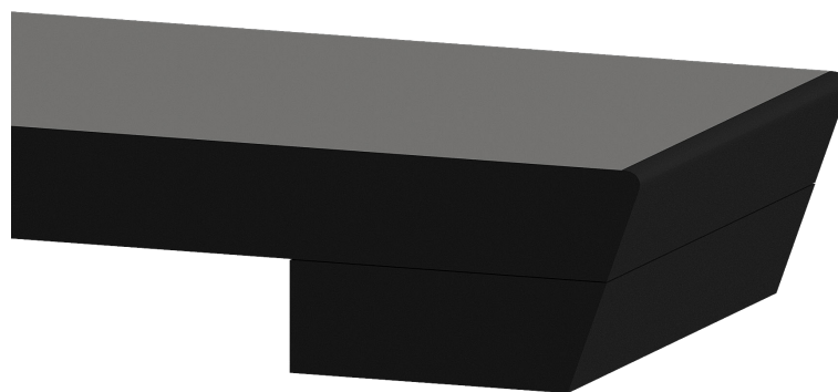
Изображение 15: увеличение толщины посредством приклеивания к пласти плиты элемента из плиты такой же толщины («ложный край»)
