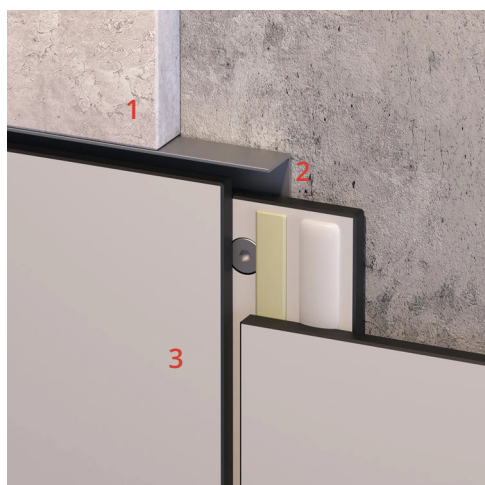
Изображение 34: установка компакт-плит заподлицо с другими элементами облицовки стен
