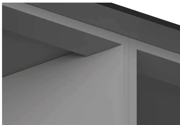
Изображение 59: верхняя часть с опорной планкой
